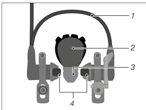
Sl.: Hidraulična kočnica obruča kotača (kao primjer)
