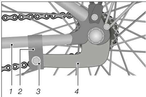
Sl.: Torpedo kočnica (kao primjer)
