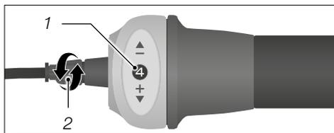
Sl.: Vijak za namještanje na okretnoj ručici mjenjača (kao primjer)
