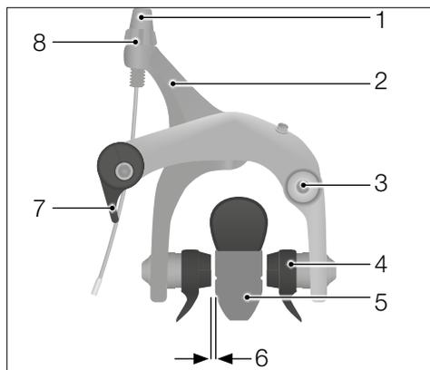
Sl.: Kočnica obruča kotača trkačkog bicikla (kao primjer)
