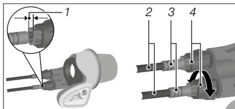
Sl.: Zazor omotača čeličnog užeta mjenjača (lijevo) i vijak za namještanje (desno) (kao primjer)
