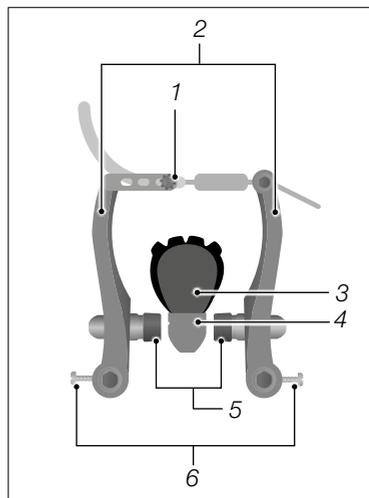
Sl.: Kočnica obruča kotača s vlačnom vodilicom (kao primjer)
