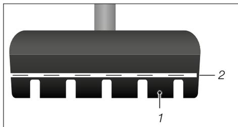
Sl.: Kočna papuča s indikatorom istrošenosti (kao primjer)
