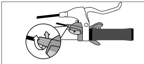
Sl.: Vijak za zatezanje čeličnog užeta na ručici mjenjača (kao primjer)
