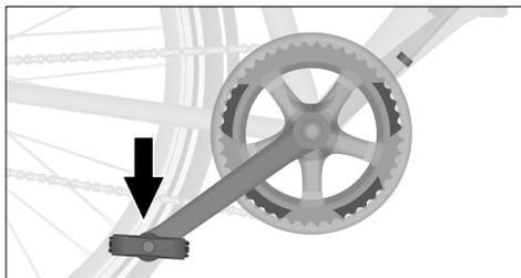
Sl.: Aktiviranje torpedo kočnice (kao primjer)
