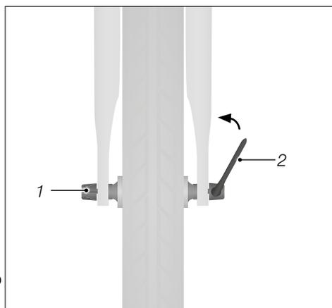
Sl.: Kotač s brzosteznom osovinom (kao primjer)
