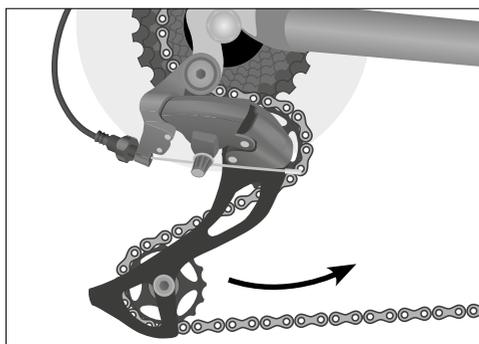
Sl.: Zatezač lanca na stražnjem kotaču (kao primjer)
