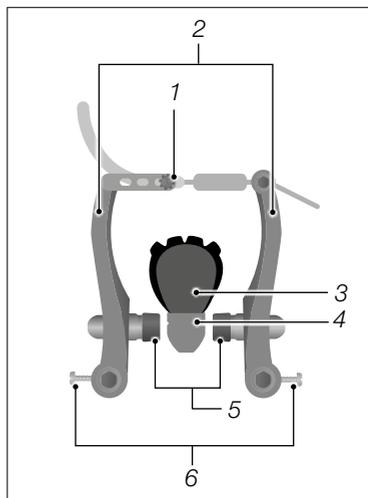
Sl.: Kočnica obruča kotača s vlačnom vodicom (kao primjer)
