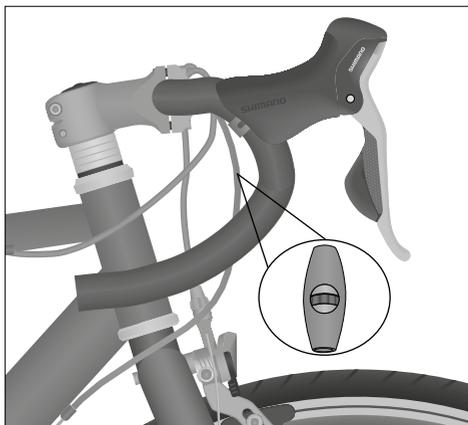
Sl.: Namještanje mjenjača s lančanicima (kao primjer), vijak za namještanje zategnutosti čeličnog užeta
