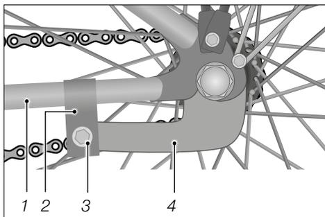
Sl.: Torpedo kočnica (kao primjer)
