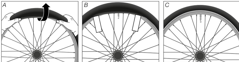
Sl.: Montaža gume sa žicom ili gume ojačane kevlar vlaknima (kao primjer)
