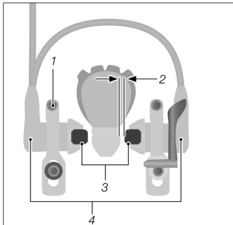
Sl.: Hidraulična kočnica obruča kotača (kao primjer)
