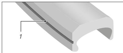
Sl.: Obruč kotača s indikatorom istrošenosti (kao primjer)
