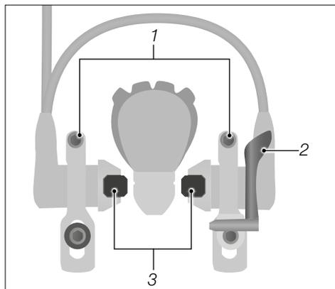
Sl.: Hidraulička kočnica obruča kotača (kao primjer)
