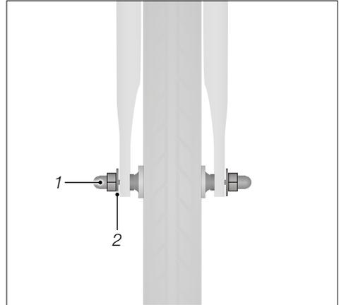
Sl.: Kotač s vijčanom osovinom (kao primjer)
