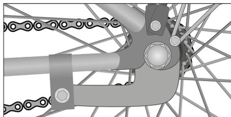
Sl.: Torpedo kočnica (kao primjer)
