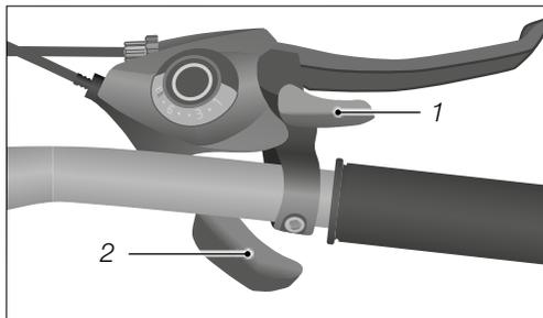
Sl.: Upravljačka jedinica na upravljaču za prebacivanje stražnjih i pogonskih lančanika (ovdje kao primjer na desnoj strani upravljača)
