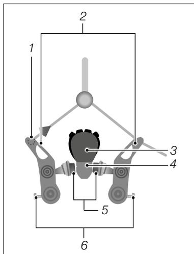
Sl.: Kočnica obruča kotača s nazuvicom čeličnog užeta (kao primjer)
