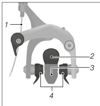
Sl.: Mehaničke kočnice obruča kotača (kao primjer)
