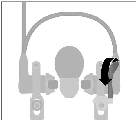
Sl.: Priprema kočnice kod hidrauličnih kočnica obruča kotača (kao primjer)
