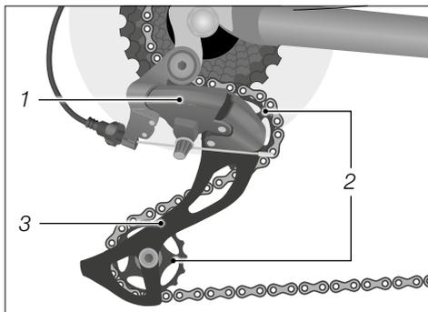
Sl.: Pokretne komponente mjenjača s lančanicima (kao primjer)
