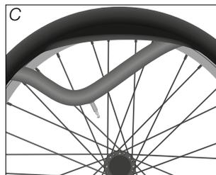
Sl.: Demontaža gume sa žicom ili gume ojačane kevlar vlaknima (kao primjer)
