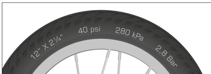
Fig.: Pneumatici con indicazione della misura (esempio)
