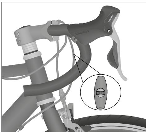
사진: 기어변속 설정(예시) 케이블 장력 조절을 위한 조절 바퀴가 달린 조절나사
