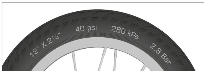
Fig.: Pneu com indicação do tamanho do pneu (exemplo)
