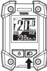
Jedes Mal, wenn Sie den Lichtschalter drücken, schaltet der Scheinwerfer zwischen „Ein“ und „Aus“ um.
