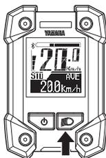
Cada vez que pulse el interruptor de luz, el faro alterna entre “Activado” y “Desactivado”.
