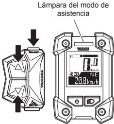
Puede seleccionar que se encienda la lámpara del modo de asistencia de acuerdo con el modo de asistencia o mantener apagada la lámpara del modo de asistencia durante todo el tiempo.
