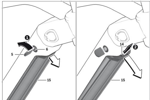
❶ Pour retirer l'accu PowerTube **15**, ouvrez la serrure **6** avec la clé **5**. L'accu se déverrouille et tombe dans le support de retenue **14**.
