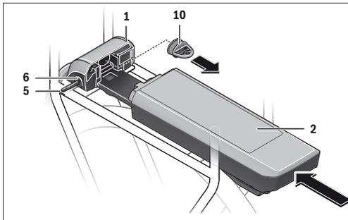
Pour pouvoir monter l'accu, la clé **5** doit se trouver dans la serrure **6** et la serrure doit être ouverte.
