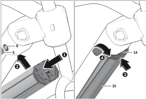
Pour pouvoir monter l'accu, la clé **5** doit se trouver dans la serrure **6** et la serrure doit être ouverte.
