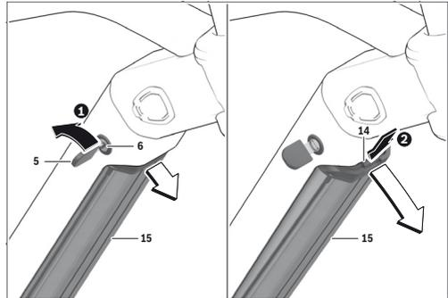
❶ Para retirar la batería PowerTube **15**, abra la cerradura **6** con la llave **5**. La batería se desbloqueará y quedará sujeta en la fijación de retención **14**.
