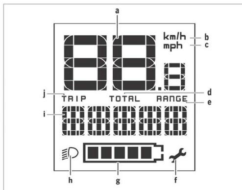
En el **velocímetro a** se indica siempre la velocidad actual. En la pantalla **i** se muestra siempre de modo predeterminado el último ajuste. Realizando repetidamente pulsaciones medias de la tecla “-”, se muestran consecutivamente el recorrido efectuado “TRIP”, el kilometraje total “TOTAL” y la autonomía restante de la batería “RANGE”. (Pulsando brevemente la tecla “-” se reduce el nivel de asistencia.)
