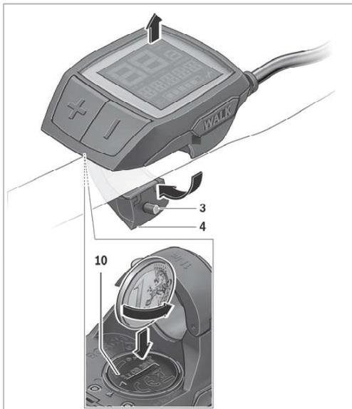
Si el ordenador de a bordo muestra “LOW BAT” en la pantalla, retirelo del manillar desenroscando el tornillo de fijación **3**. Abra la tapa del compartimento para baterías **10** con una moneda adecuada, extraiga las pilas gastadas y coloque pilas nuevas del tipo CR 2016. Puede adquirir las baterías recomendadas por Bosch en su establecimiento especializado.
