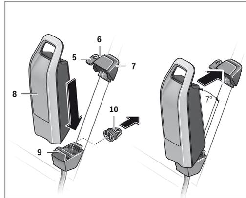
Pour pouvoir monter l'accu, la clé **5** doit se trouver dans la serrure **6** et la serrure doit être ouverte.
