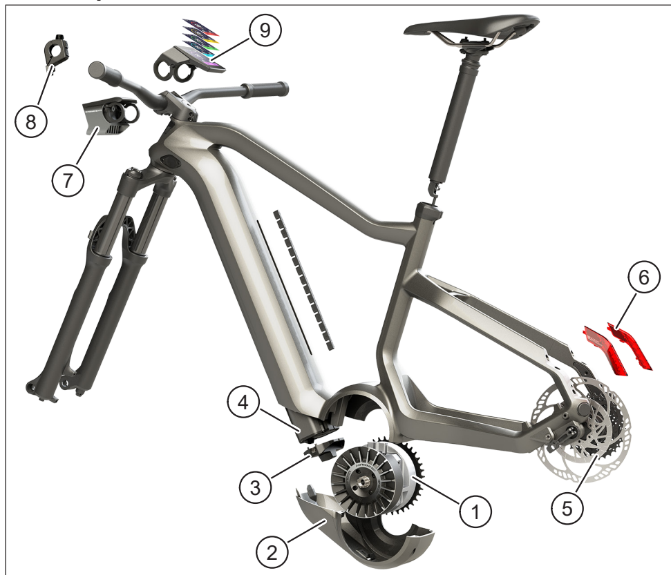
Fig. 1: Composants du système d'entraînement FLYON
