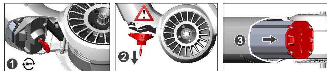
**cs** Sejměte akumulátor „Intube“: Zámek odblokujte otočením doprava (1), odeberte zámek a pevně držte akumulátor (!) (2), akumulátor vytáhněte za prohlubeň na rukojeti (3) a odeberte směrem dopředu (4)
