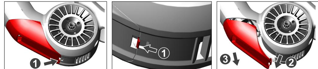
**cs** Sejměte „Skidplate“: Skidplate na pružině odblokujte směrem dopředu (1) a pak směrem dolů (2) a dozadu (3) sejměte
