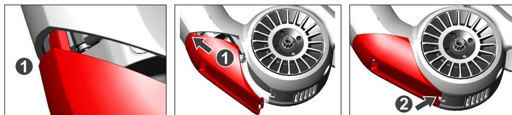
**cs** Skidplate vložte do spodní trubky (1) a poté zaklapněte směrem nahoru (2); pružina musí slyšitelně zavaknout (3)
