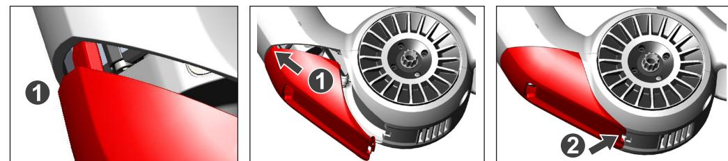
**da** Isæt skidplate i det nederste rør (1), og klap det derefter opad (2); fjederen skal gå i indgreb, så det kan høres (3)
