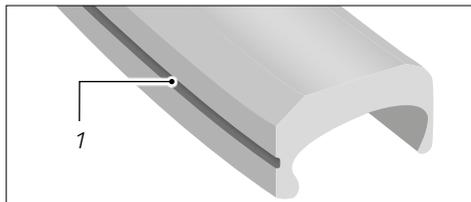
Fig.: Llanta con indicador del desgaste (ejemplo)
