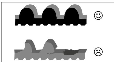
Fig.: Desgaste de la correa (ejemplo)
