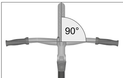
Fig.: Alineación correcta del manillar (ejemplo)
