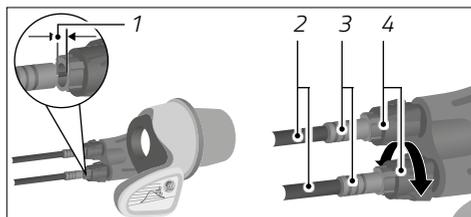
Fig.: Holgura del revestimiento del cable del cambio (izquierda) y tornillo de ajuste (derecha) (ejemplo)
