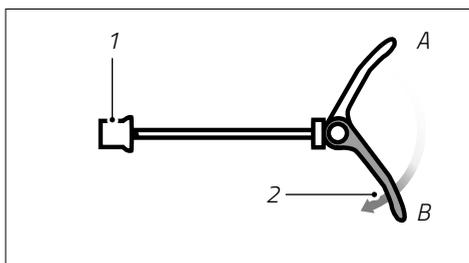
Fig.: Montaje del cierre rápido (ejemplo)
