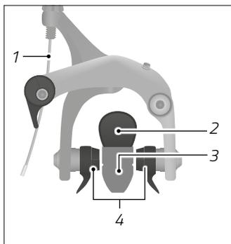
Fig.: Freno de llanta mecánico (ejemplo)
