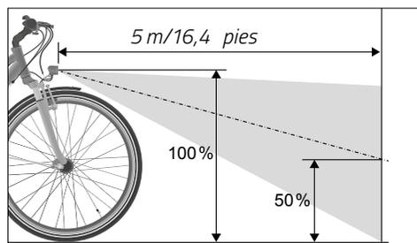
Fig.: Ajuste de la luz delantera (ejemplo)
