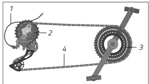
Fig.: Componentes de un cambio de cadena (ejemplo)
