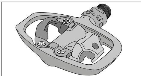
Fig.: Pedal automático (ejemplo)
