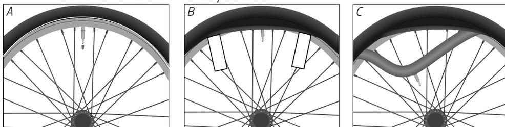
Fig.: Desmontaje de los neumáticos radiales (ejemplo)
