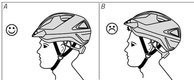
Fig.: Asentamiento del casco ((A) correcto, (B) cae demasiado atrás)
