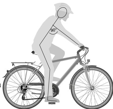
Fig.: altura óptima del sillín (a modo de ejemplo)
