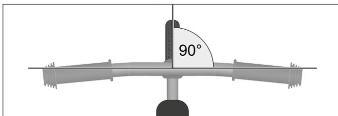
Fig.: Alineación correcta del manillar (ejemplo)
