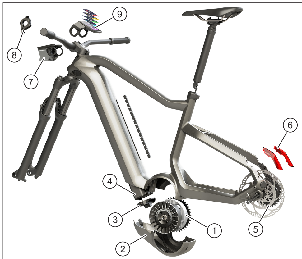
Εικ. 1: Εξαρτήματα του συστήματος πρόωσης FLYON
