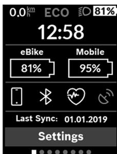
Na stavové obrazovce se vedle stavové lišty zobrazuje aktuální čas, stav nabítí všech akumulátorů systému eBike a stav nabítí akumulátoru chytrého telefonu, když je chytrý telefon spojený přes Bluetooth®.
